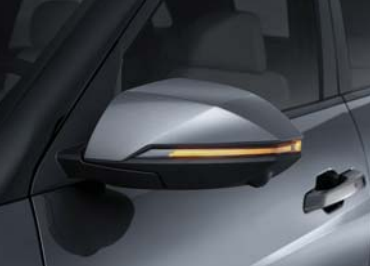
Espejos retrovisores laterales (intermitentes LED)
