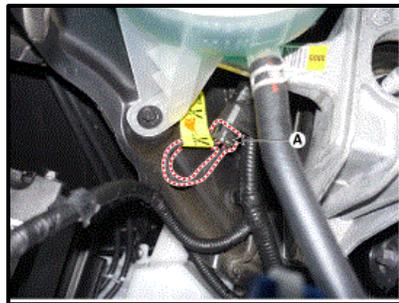
Si no puede desconectarse el conector de interbloqueo de servicio, corte el cable del conector de interbloqueo de servicio.
