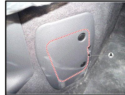
4. Desenganche el gancho (A) y retire el enchufe de seguridad (C) empujando la palanca (B) hacia la dirección de la flecha
