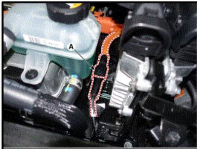
2. Desconecte el conector de interbloqueo de servicio (A).
