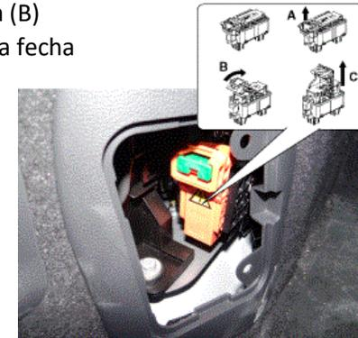
5. Espere más de 5 minutos para que el capacitor del sistema de alto voltaje se pueda descargar completamente.
