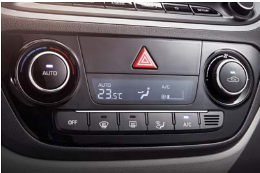
Control automático de acondicionamiento de aire
